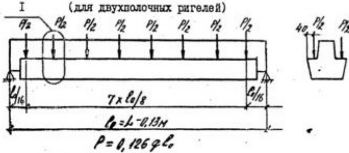
Схема №3. Опирания и загрузки ригеля для испытаний перед началом массового изготовления конструкций или внесении конструктивных изменений, или при изменении технологии изготовления, вида и качества применяемых материалов.
